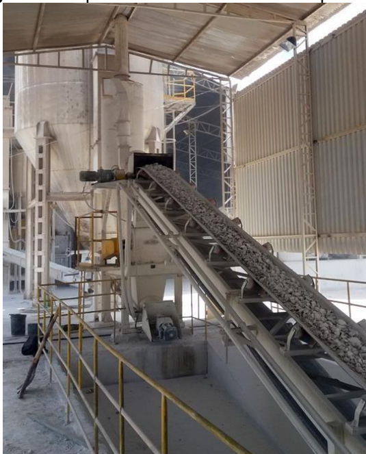
Figura 3 – Gipsita britada em esteira transportadora
