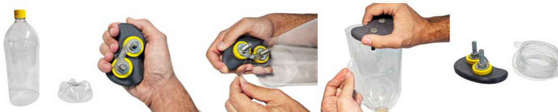
Figura 5 – Etapa 4, corte com a filetadora no PSS-A
