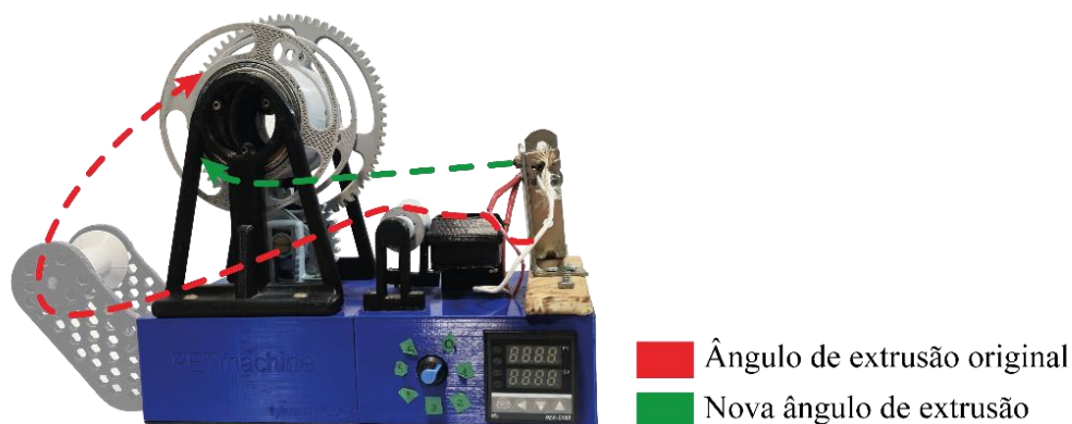
Figura 7 – Alterações na guia da extrusora desenvolvida no PSS-A
